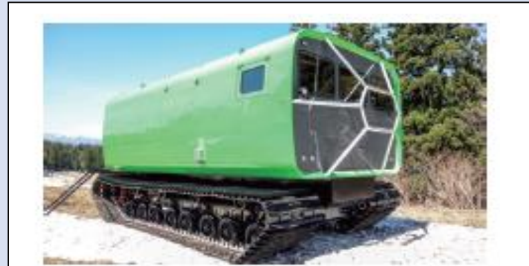
車両周囲の雪の移動の影響が軽減された南極内陸観測用雪上車
