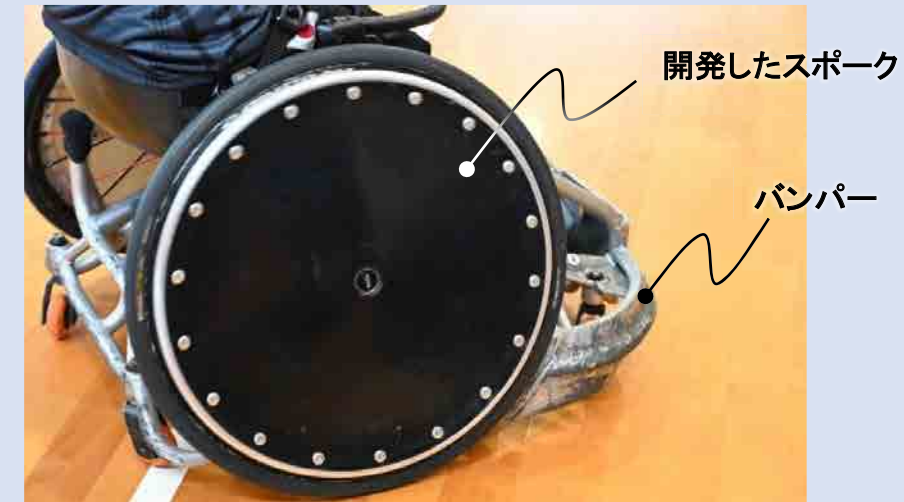
図. 新材料製スポークガードを搭載したラグ車
