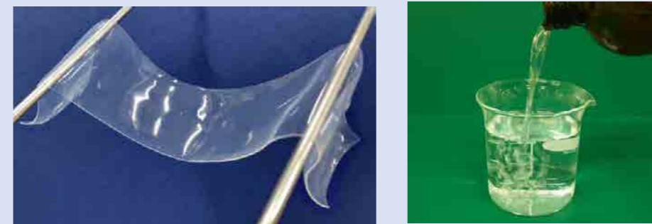
本技術のゲル状電解質（半固体化） 従来の電池に使用されている電解液
