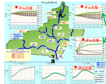
リアルタイム河川・ダム管理システム
