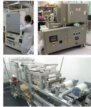
図5 大学工場;結晶材料量産装置:上左 4kg/h、上右 1kg/h、分離膜の成膜装置:下
