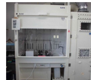
ドラフトチャンバー内の有機合成等で発生するガス等を排出
