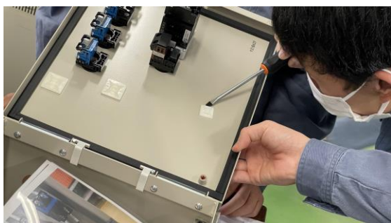
配線、スイッチ類の組み付け
