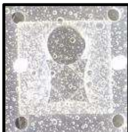
Fig. 24 大量の気泡の混入
