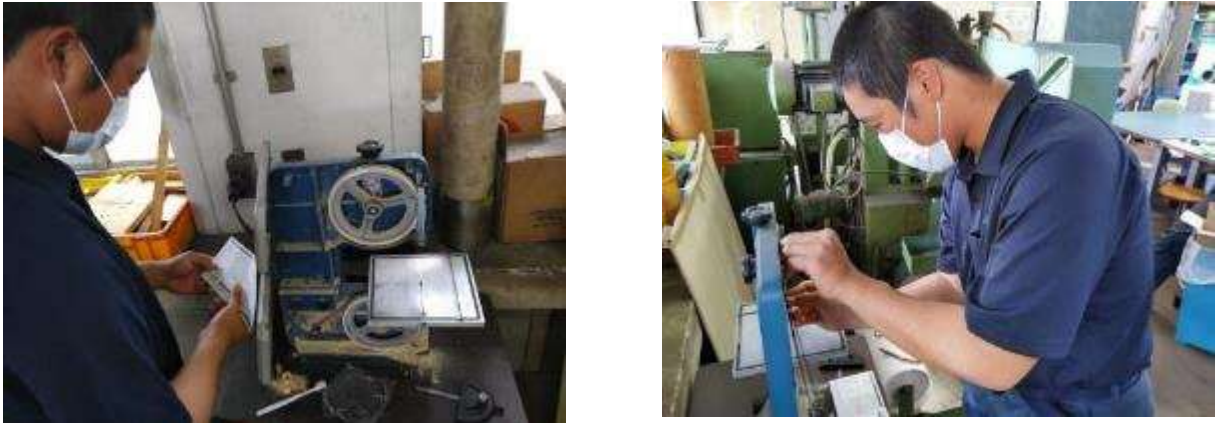
Fig. 8 切断機の仕組みの理解とバンドソー交換作業
