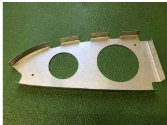
Fig29 Fig30 リブの部品 アルミ製
