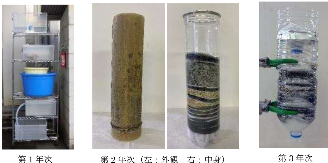
Fig.5 本研究で製作した水ろ過装置
