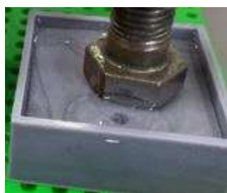
Fig. 24 大量の気泡の混入
