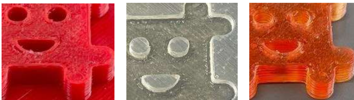
Fig. 14 押出方式3Dプリンタで製作した雄型 (左)、シリコン型 (中)、製品 (右)
