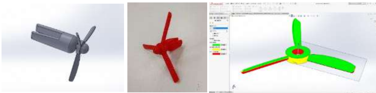
Fig. 3 デザインしたプロペラのデータ（左）と積層品（中）、勾配についての評価（右）
