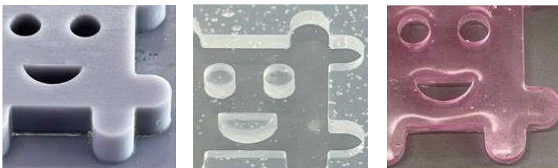
Fig. 15 光造形方式3Dプリンタで製作した雄型 (左)、シリコン型 (中)、製品 (右)
