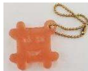
Fig. 8 3Dデータ → 3Dプリンタ → シリコン型からキーホルダー製作
