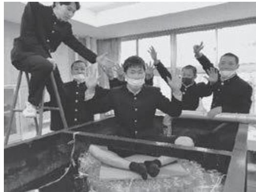
今回作成した構造でペットボトルを組み上げると、負荷のかかる部分だけペットボトルが沈み、安定しなかった〔実験1回目〕ので、合板を利用することで安定して乗ることができた。〔実験2回目〕
