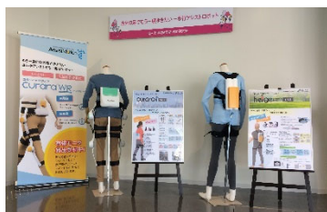
最先端の介護ロボットを展示(腰から脚に装着して歩行動作などを補助する装着型歩行支援ロボット)
