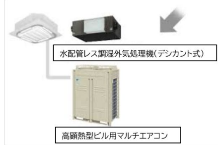
換気に水配管レス調湿外気処理機(デシカント方式)を導入し除湿機能を持たせることで、より高効率な高効率型ビル用マルチエアコンとの組み合わせが可能となり、快適性と省エネ性を両立している。
