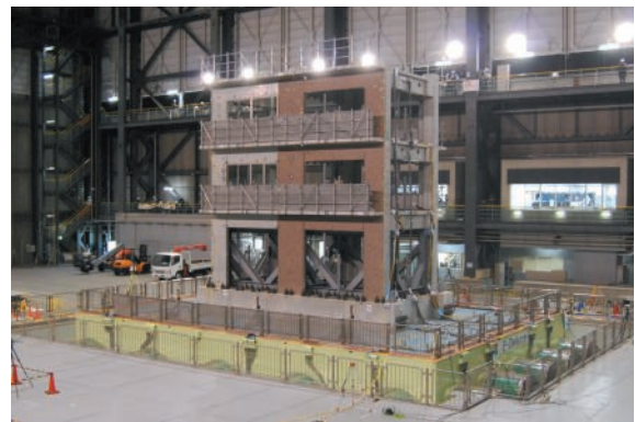
災害拠点建物の災害時機能継続性検証のため、令和元年12月に実施した3階建て鉄筋コンクリート造建物試験体のE-ディフェンス振動台実験の様子（写真提供：防災科学技術研究所（NIED））
