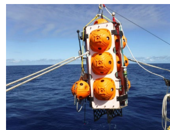
「江戸っ子1号」を利用した深海底での生分解プラスチック分解試験 https://www.jamstec.go.jp/j/about/press_release/20200305/
