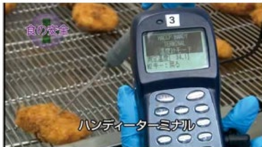
画14 中心温度は筆記用具を使用せず記録が自動的に管理される
