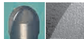
PLG 加工した CBN ボール エンドミル(左)と切れ刃(右)
