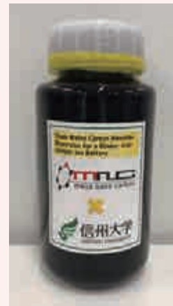
(左上) 正極材料 (NCM811)、(左下) バインダーフリー導電剤を搭載したラミネル電池、(右) カーボンナノチューブを用いたバインダーフリー導電剤
