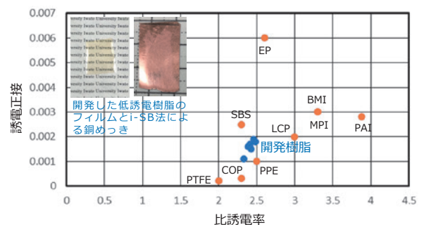
開発樹脂と一般的な低誘電樹脂材料の比誘電率と誘電正接
