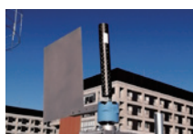
CFRP 模型による 風振動発電技術
