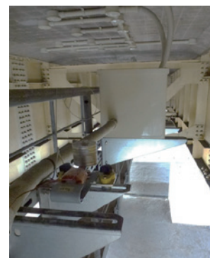
実橋に設置した振動発電デバイス
