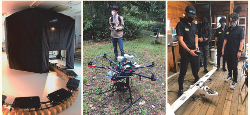
全照射角度・計測角度に対する全自動スペクトル計測システム (左)。ライダーと分光器を搭載したドローン (中央)。ビジネス運用を目的とした垂直離着陸機 (右)。
