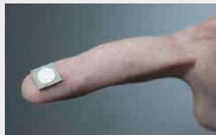
搭載されている新開発のディスポーザブルマイクロポンプ
