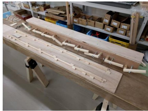
ラダーの桁製作治具と組み立て定盤
