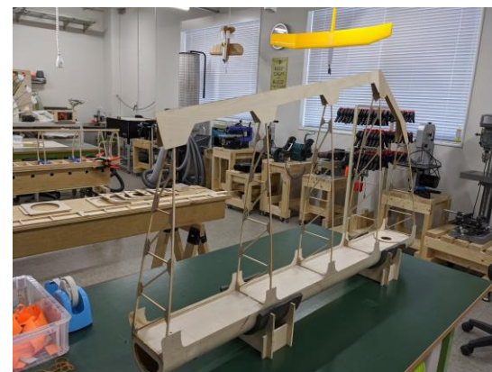
2号機ラダーの完成
