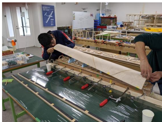
ラダーDボックスの製作
