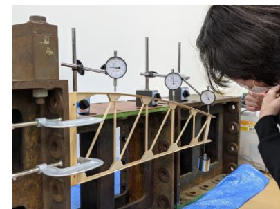
主翼リブの剛性評価試験
