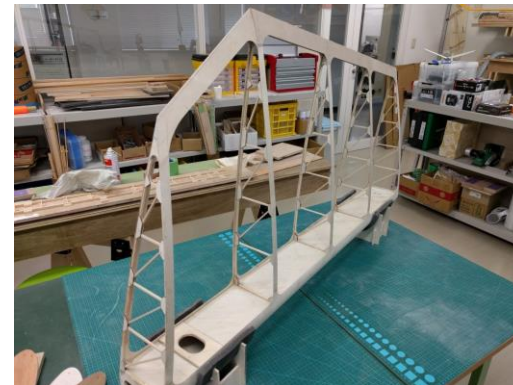
ラダーの完成
