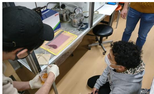
VaRTM法によるCFRP板の製作
