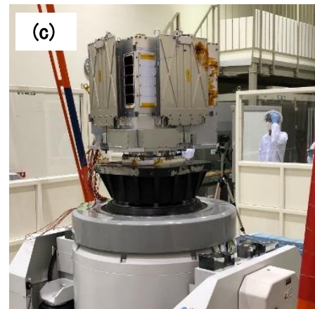
(c) EMシステム振動試験の様子
