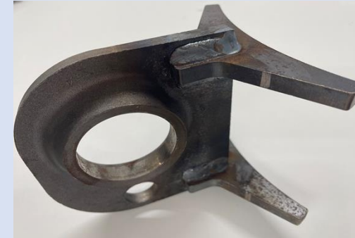
写真1 バーリングプレス加工した鋼板の接合要素を活用した杭頭接合用デバイス
