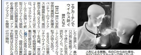
人形による実験。右の口から出た煙を、左の口元のエアカーテンで防いでいる
