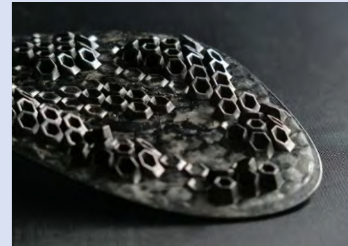
複雑な形状のハニカム構造をプレス加工で大量生産できる
