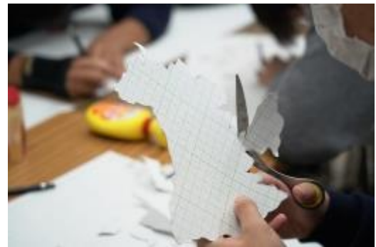
型を合わせてカット後、5枚貼り合わせる。
