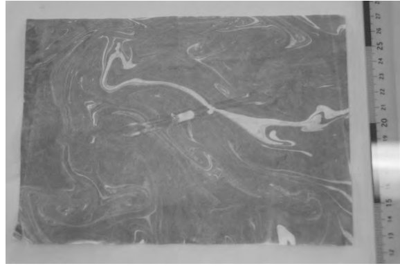
壁紙 (柿渋塗布した2枚の間に竹炭をサンド)
