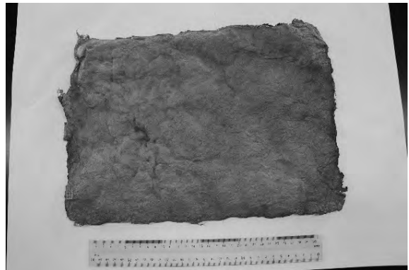
壁紙 (柿渋塗布した2枚の間に竹炭をサンド)
