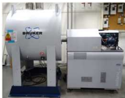
令和3年福島県沖地震により質量分析装置内部の精密機器が破損
