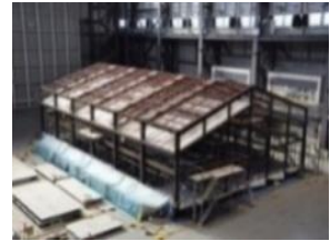
▲E-ディフェンスによる震動実験
