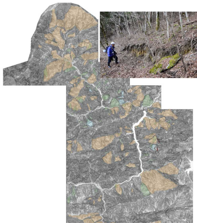
図 10. 0.5mDEM に基づく重力変形、地すべり、過去の崩壊痕跡、急崖など、項目別に分類した危険斜面の分布（国道 194 号線の例）（京都大学防災研究所 [課題番号：DPRI10]）挿入写真は、長期的な重力変形の影響を受けていると判断された四国の主要国道沿いの斜面における斜面上方の段差亀裂の様子を示す。
