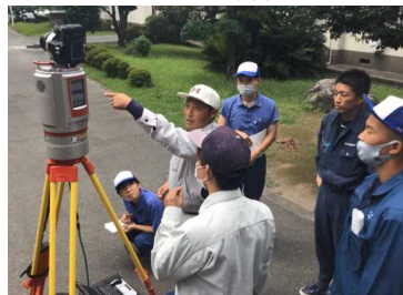
地上レーザー測量
