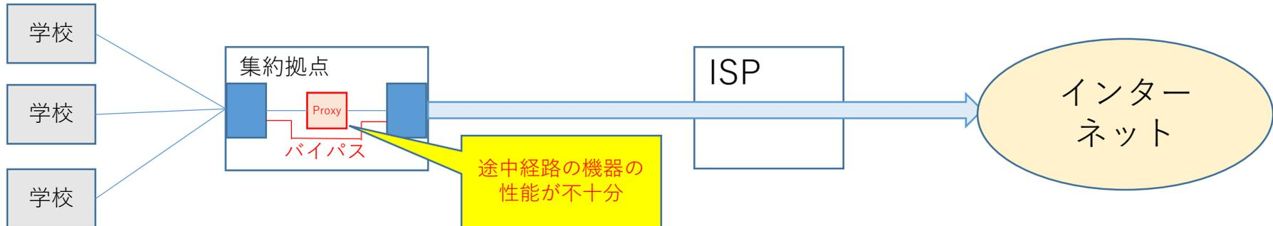
【不良原因】 利用頻度の増加に伴い、インターネットへのアクセス量が増加した結果、プロキシサーバ（中継サーバ）の処理能力を超過
