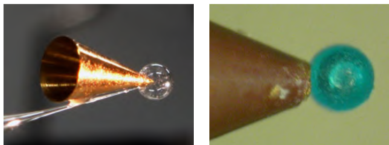
コーンによる効率的な加熱 中実球による安定な爆縮 R. Kodama et al., Nature (2001) S. Sakata et al., Nature Commun. (2018) K. Matsuo et al., Phys. Rev. Lett (2020) S. Fujioka et al, Phys. Rev. E, (2015) H. Sawada et al., APL (2016)
