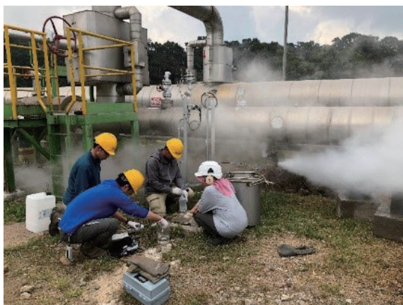
温泉水及びガスを分析する様子 SATREPS 「インドネシアにおける地熱発電の大幅促進を目指した 蒸気スポット検出と持続的資源利用の技術開発」 （写真提供：京都大学）
