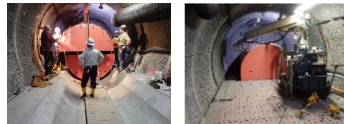
模擬廃棄体を用いた幌延地下坑道での搬送定置試験の様子 (現場オペレーション)
