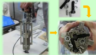
Na中リースパーツ回収治具の検討・試作
