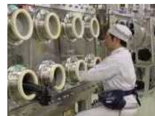
酸素が少ない深部地下環境を模擬した場での放射性核種の移行挙動の把握 (東海・地層処分放射化学研究施設(QUALITY))
