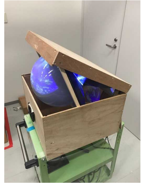
可搬型折畳什器:展開時:蓋を開けることで ドームが展開され、立体表示が可能となる
