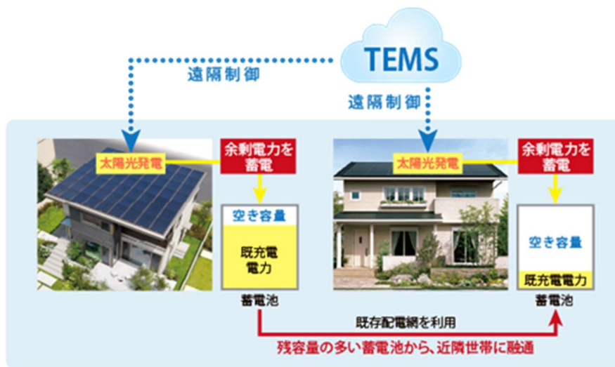
図表 5-2.6.4a セキスイハイムの TEMS による遠隔制御過程 (出所) セキスイ版スマートシティづくりの一例 (セキスイハイムの HP より)
