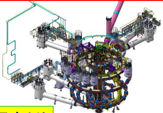
冷媒配管、超伝導コイル、遮熱板からなる被冷却機器
