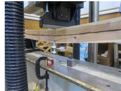
炭素繊維と木材の複合材料の曲げ試験
