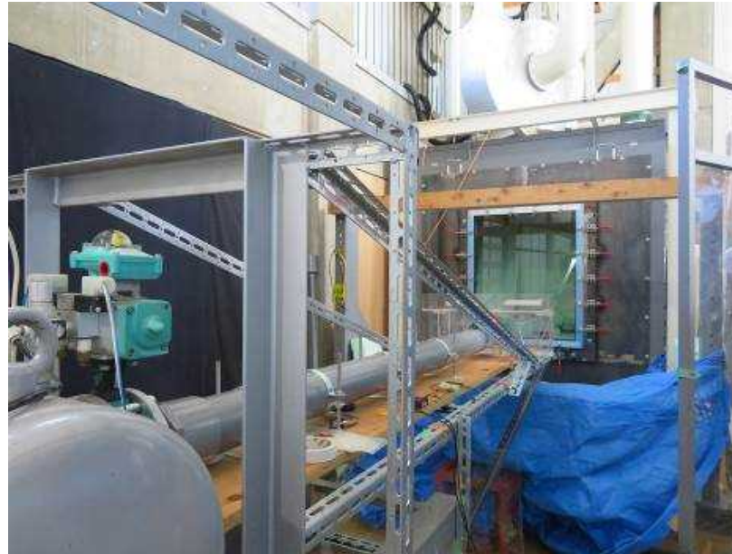
衝撃試験装置を用いたウインドウフィルム貼りガラスに対する衝撃試験
