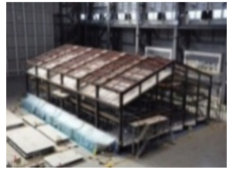
▲E-ディフェンスによる震動実験
