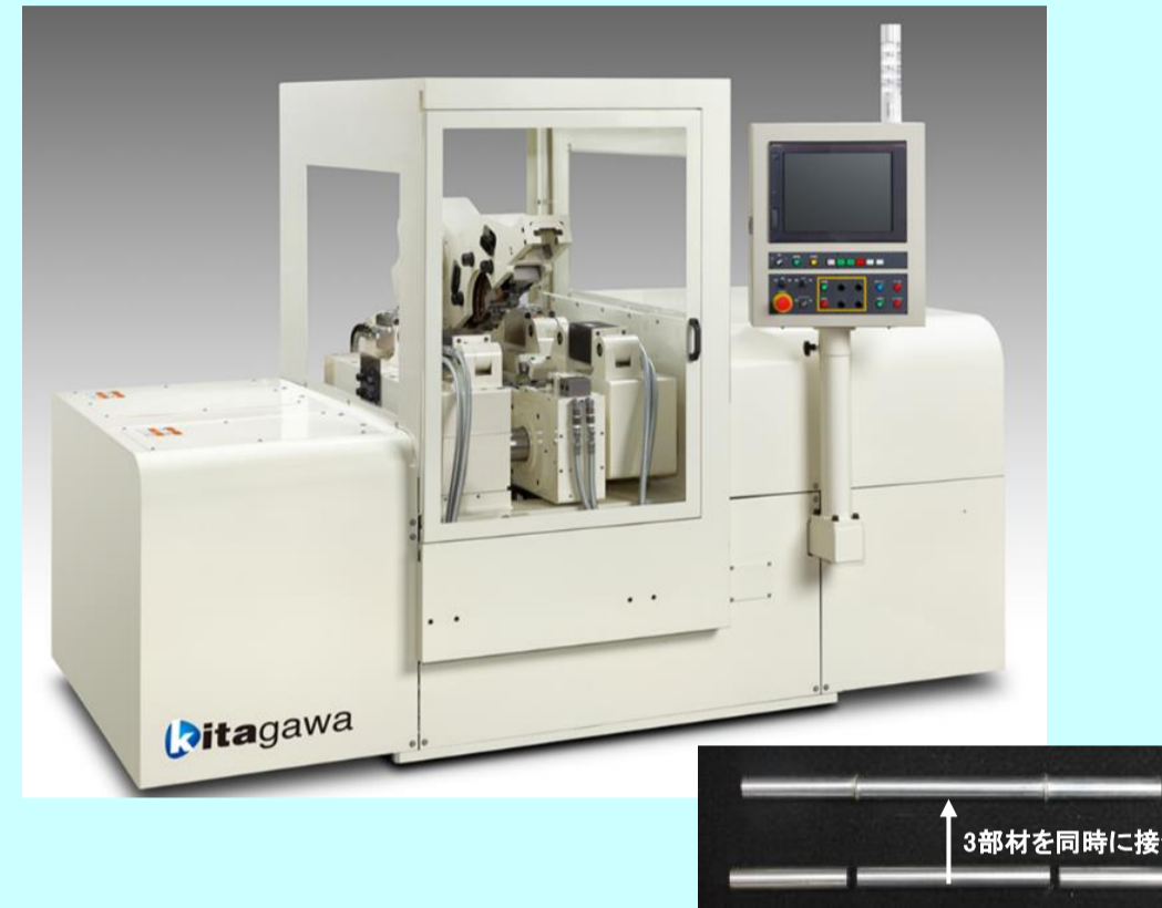
図1 接合装置の外観写真およびアルミニウム合金継手
