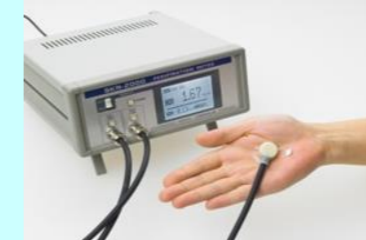
図1 換気カプセル型発汗計の測定例
