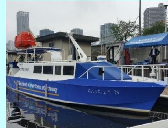
図2. 東京海洋大学で開発した電池推進船 (らいちょうN)
