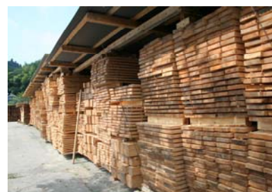
床板材(ヒノキ)の乾燥状況
