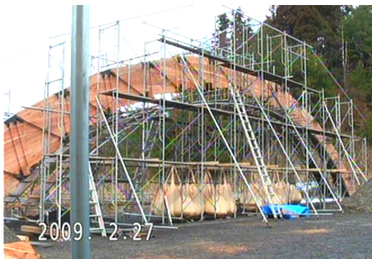
中央荷重の実物大実験
