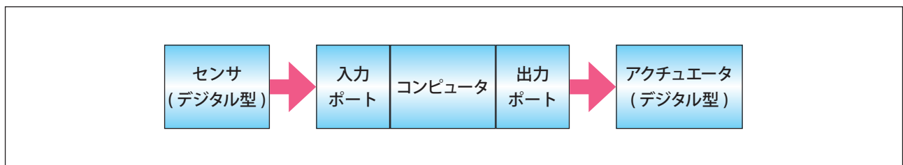
図表1 デジタル型のセンサやアクチュエータによるコンピュータ計測制御システム
