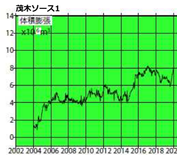
図2 (上) 観測点配置および推定された力源の位置 (下) 力源の堆積膨張量 力源としては、球場圧力源 (茂木ソース) を仮定
