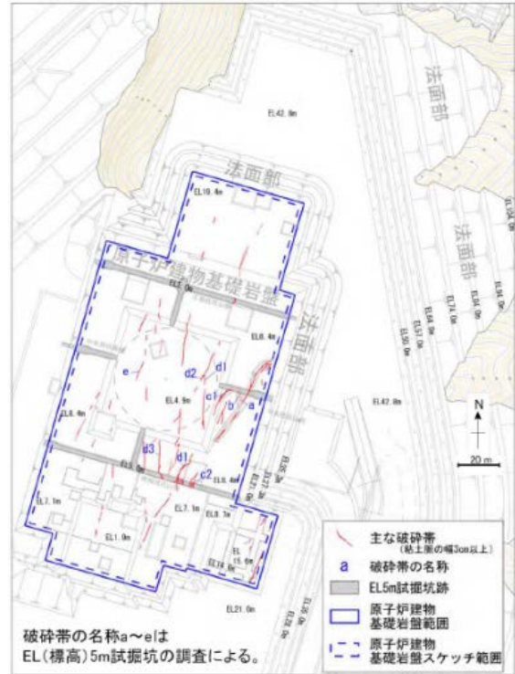
原子炉建物基礎岩盤 における破碎帯分布図
