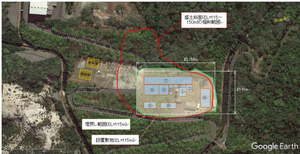
図 5-31 ⑧焼却炉場所に試験研究炉（低出力研究炉＋臨界実験装置）を設置する場合の施設配置（Google Earth の写真に重ねた図）
