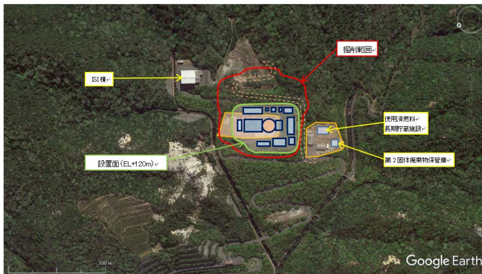
図 5-26 ⑥山側資材置場と⑧焼却炉場所に試験研究炉（中出力研究炉）を設置する場合の必要な敷地広さ
