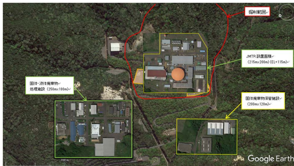
図 5-28 ⑥山側資材置場と⑧焼却炉場所に試験研究炉（JMTR 相当）を設置する場合の必要な敷地広さ
