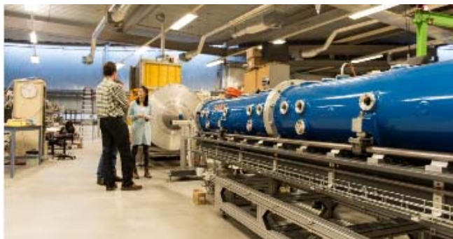
図 5-59 HOR 炉の小角散乱試験装置 17)
