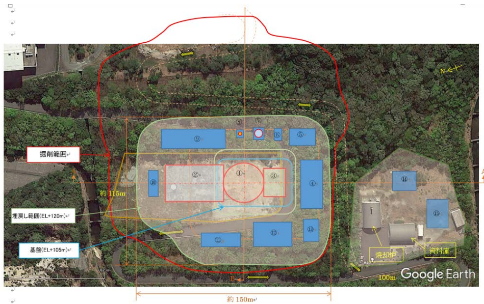
図 5-39 ⑥山側資材置場に試験研究炉 (中出力研究炉) を設置する場合の施設配置 (Google Earth の写真に重ねた図)
