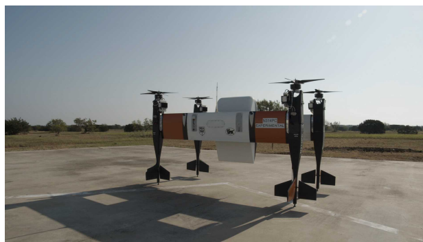
図 51 貨物用 eVTOL システムの実証実験
