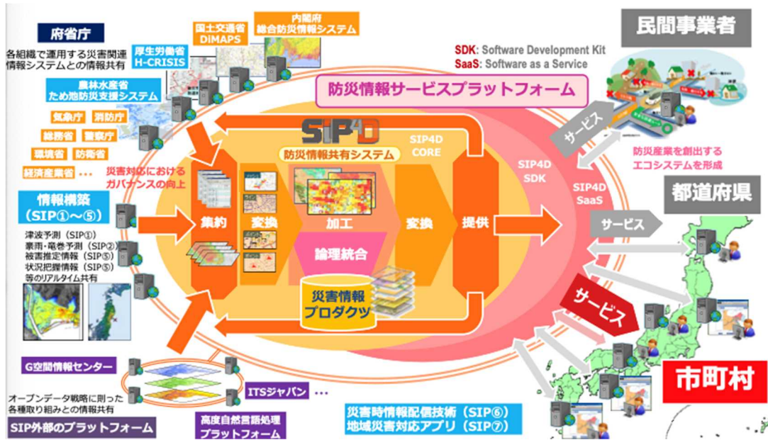
図 36 災害対応実務を支援するサービス（防災情報サービスプラットフォームのプロトタイプ）
