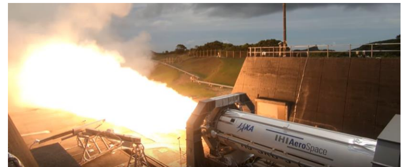
SRB-3地上燃焼試験(2019年8月)
