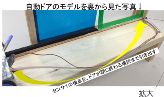
自動ドア模型に利用した際のセンサ 3, 4 (赤外線センサ) の様子
