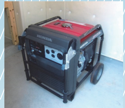
可搬型の非常用発電機
