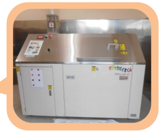
給食の食べ残しなどを生ゴミ処理機で堆肥化し、学校の花壇等に利用（新潟県五泉市立五泉小学校）
