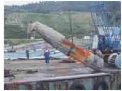
急潮により被害を受けた定置網の台浮子
