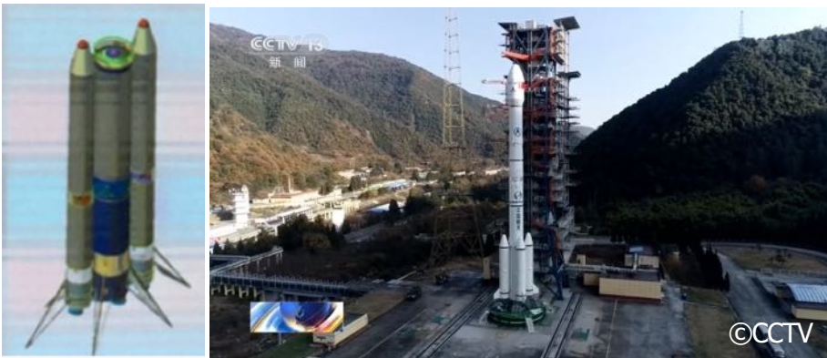
長征8号の1段再使用化の検討例と開発中の長征8号
