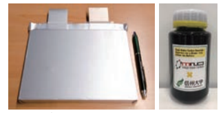
バインダーフリー導電助剤を搭載したラミセル電池(下左)、カーボンナノチューブを用いたバインダーフリー導電助剤(下右)
