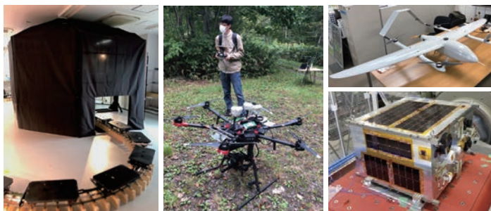
全照射角度・計測角度に対する全自動スペクトル計測システム(左)。 ライダーと分光器を搭載したドローン(中央)。 ビジネス運用を目的とした垂直離着陸機(右上)。 最新の分光カメラを搭載した超小型衛星(右下)。
